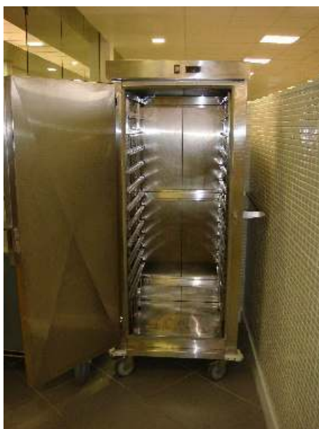
Figura 4.26 - Estufa com rodízios e trilhos que acomodam formas padrão GN. Fonte: arquivo pessoal, 2012
