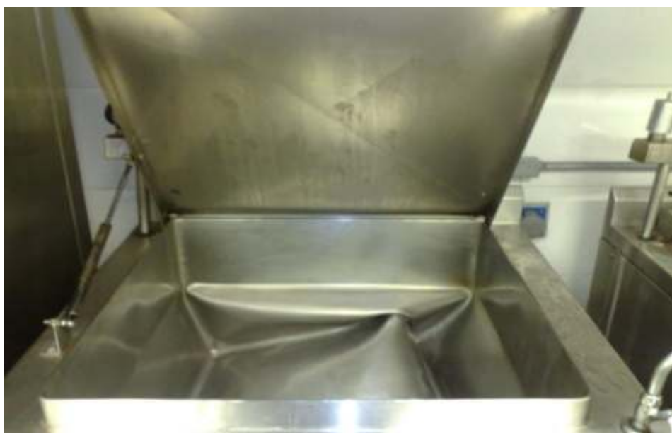
Figura 4.30 - caldeirão depois da explosão. Fonte: arquivo pessoal, 2013.
