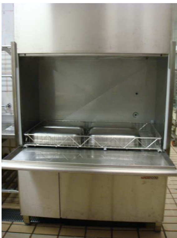
Figura 2.8 - Máquina de lavar cubas e utensílios. Fonte: arquivo pessoal.
