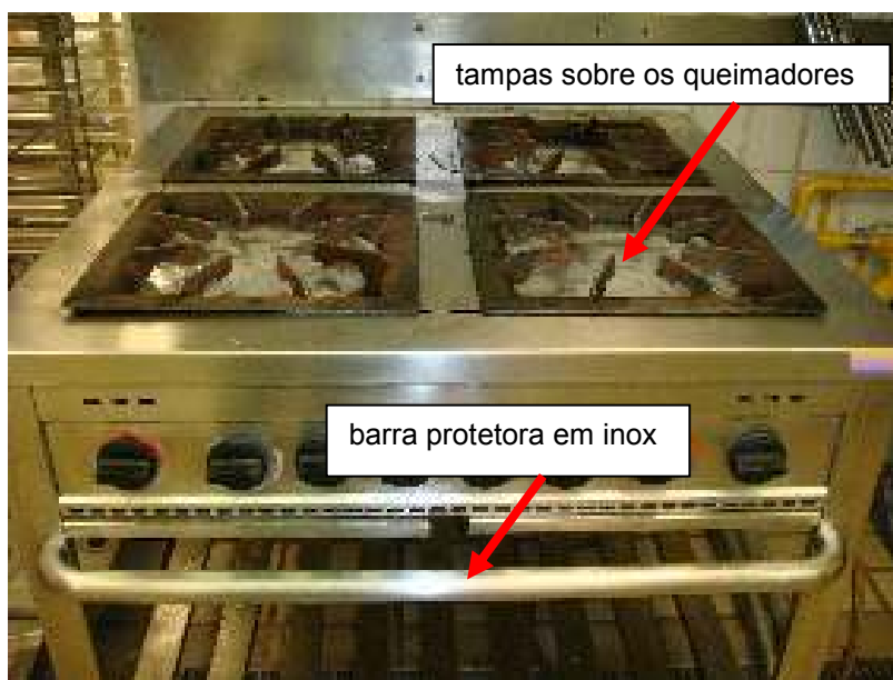
Figura 2.16 - Fogão com protetor contra batidas.
