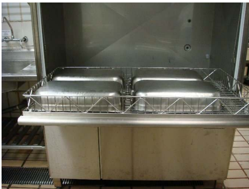
Figura 4.19 - Trilho móvel da máquina de lavar cubas. Fonte: arquivo pessoal, 2012.
